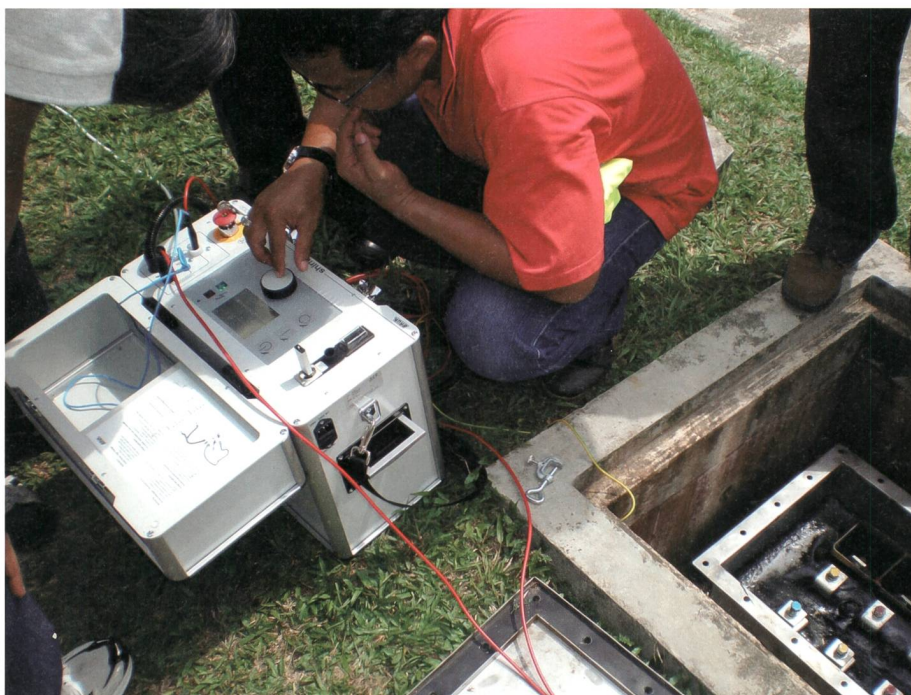
Erdfähige, niederohmige und hochohmige Fehler lassen sich zum Beispiel mit dem transportablen Mantelprüf- und Fehlerortungsgerät Baur Shirla orten.
