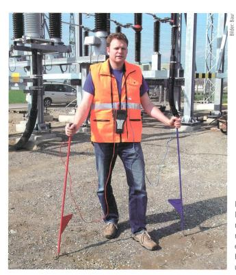
Die Nachortung von Mantelfehlern gelingt mit der Schrittspannungsmethode und entsprechenden Handgeräten schnell und präzise.
