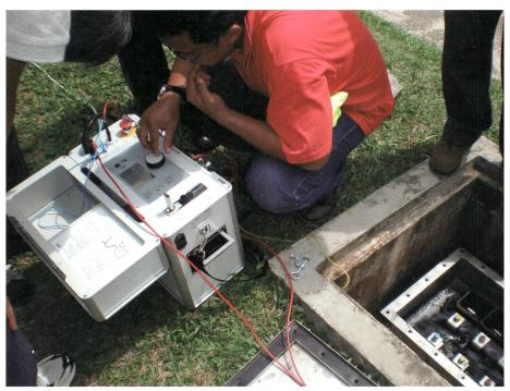
Erdfühlige, niederohmige und hochohmige Fehler lassen sich zum Beispiel mit dem transportablen Mantelprüf- und Fehlerortungsgerät Baur Shirla orten.
