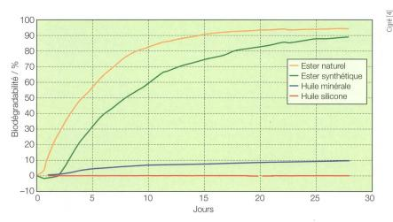
Figure 1 Biodégradabilité de divers fluides.
