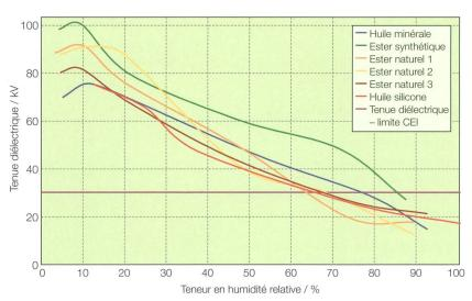
Figure 2 Tenue diélectrique en fonction de l'humidité.
