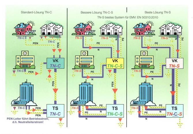
Bild 2 Elektrische Netzsysteme im Stromverteilnetz: TN-C, TN-C-S, TN-S. Durch Mehrfacherdungen des PEN-Leiters entstehen vagabundierende Ströme.
