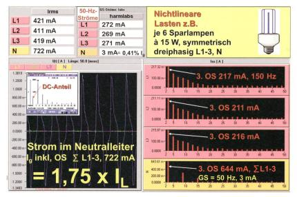
**Bild 3** Oberschwingungen erhöhen den Strom im Neutralleiter. Bei dreiphasig symmetrisch angeschlossenen Sparlampen addieren sich die Oberschwingungsströme des Nullsystems aller drei Polleiter im Neutralleiter. Der Gesamtstrom im Neutralleiter ist 1,75 mal grösser als der Polleiterstrom.
