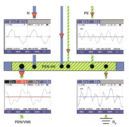
**Bild 1** Der Strom im Neutral- und PEN-Leiter wird zunehmend mit Störgrössen belastet. Der am stärksten verzerrte Strom fliesst immer über die Erdungsanlage und das «ohmsche» Erdreich. Durch die Mehrfacherdungen sind die Stromflüsse im PEN-Leiter oft schwer erklärbar.
