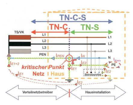
**Bild 6** In Gebäuden sollten nirgends kombinierte Neutral- und Schutzleiter (PEN) eingesetzt werden. Der Verteilnetzbetreiber sollte stets TN-S-Anschlüsse verwenden, weil dies «hausgemachte» EMV-Probleme durch Mehrfacherdungen des PEN-Leiters verhindert.
