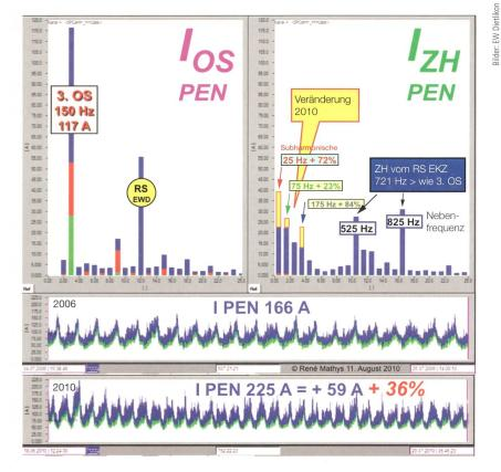
**Bild 9** Zunahme des PEN-Leiterstroms zwischen 2006 und 2010 in einer Trafostation, die nur Wohngebäude versorgt. Neue Gebäude sind in dieser Zeit nicht dazugekommen.
