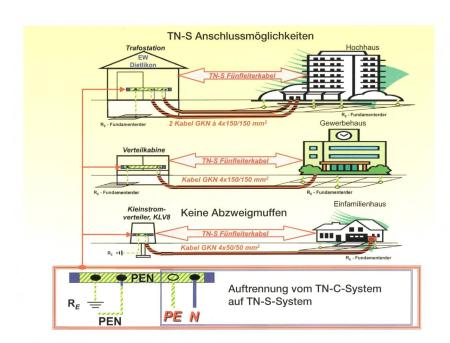
**Bild 5** TN-S-Anschlüsse können direkt von der Trafostation, Verteilkabine oder von einem Kleinstromverteiler erstellt werden. Bei den Anschlüssen werden die bisherigen Betriebsmittel genutzt. Es entstehen somit keine weiteren Kosten. Es sollten auf keinen Fall Anschlüsse über Abzweigmuffen erstellt werden.
