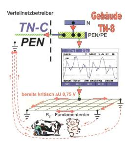
empfindlicher als Menschen. Bereits Spannungsdifferenzen von 0,75 V können Tiere in ihrem Wohlbefinden massiv beeinflussen. Bei oberschwingungs- und zwischenharmonisch behafteten Strömen erhöht sich die Impedanz von Kabelleitungen. Dagegen bleibt der Widerstand vom Erdreich praktisch unverändert. Folglich werden diese Ströme in TN-C-Systemen weiter zunehmen. Die über das Erdreich fliessenden Ströme können auch als «Fehlerströme» oder «Streuströme» bezeichnet werden.
