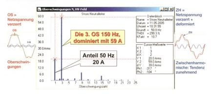
**Bild 7** Die Kabelquerschnitte müssen nach den Oberschwingungslasten im Neutralleiter bemessen werden, da der Strom im Neutral-/PEN-Leiter im Extremfall das 2,2 bis 2,4fache des Polleiterstroms beträgt.
