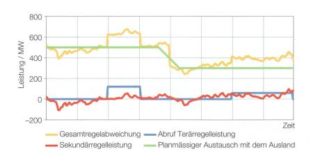
**Bild 1** Exemplarische Darstellung der Netzregelung mit Sekundär- und Tertiärregelung in der Schweiz
