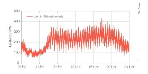
**Bild 2** Aufgrund grosser Einzellasten und des Taktfahrplans weist das Schweizer Bahnstromnetz hohe Lastgradienten auf (Lastprofil von Mai 2011).
