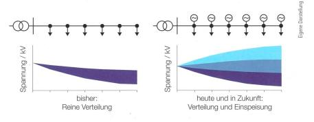
**Bild 3** Veränderung der Aufgabe der Spannungshaltung in Verteilungsnetzen bei Zunahme dezentraler Erzeugung (schematisch).
