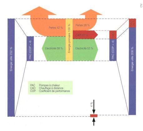
**Figure 7** Comparaison des bilans énergétiques avec (à droite) ou sans (à gauche) utilisation partielle de la chaleur pour des applications de chauffage à distance.
