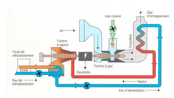
Figure 1 Schéma du principe de fonctionnement d'une centrale à cycle combiné.
