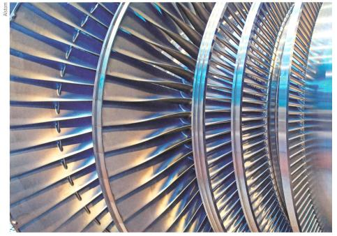
Figure 3 Etages d'une turbine à vapeur.
