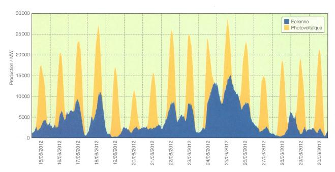
Figure 3 Production électrique photovoltaïque et éolienne en Allemagne au cours de la seconde moitié de juin 2012 [3].
