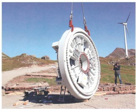
Bild 3 Der 0,9-MW-Generator der neuen Gütsch-Windkraftanlage.
