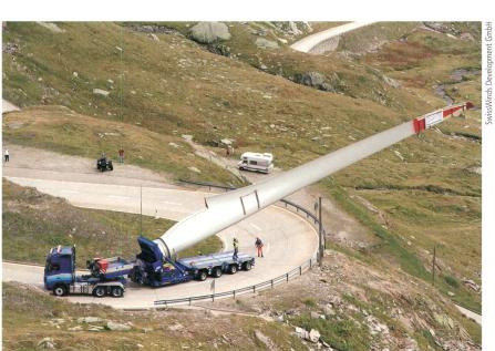
**Bild 2** Transport eines Rotorblattes zur europaweit höchstgelegenen Windkraftanlage bei Ulrichen im Wallis. Je nach Bedarf kann das Rotorblatt entsprechend (bis zur Senkrechten) angehoben werden
