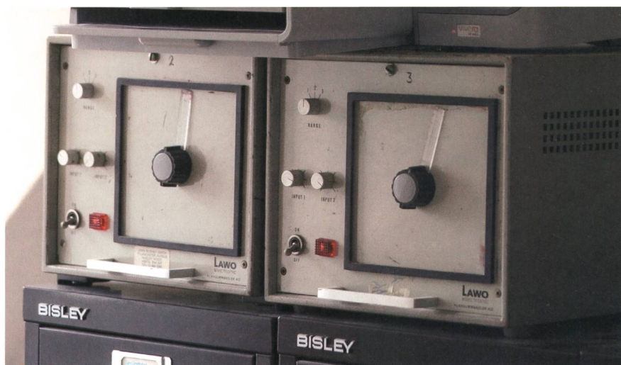
Bild 5 Die analogen Lawo-Ringmodulatoren, die lange von John Rushby-Smith verwendet wurden.
