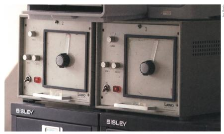
Bild 5 Die analogen Lawo-Ringmodulatoren, die lange von John Rushby-Smith verwendet wurden.
