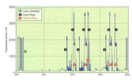
Figure 1 Mesure de la puissance consommée par un des ménages considérés pendant 24 h.
