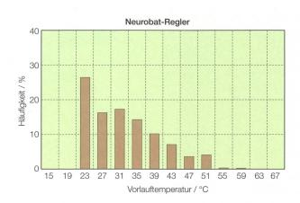
Bild 4 Vorlauftemperaturverteilung im CSEM-Gebäude.
