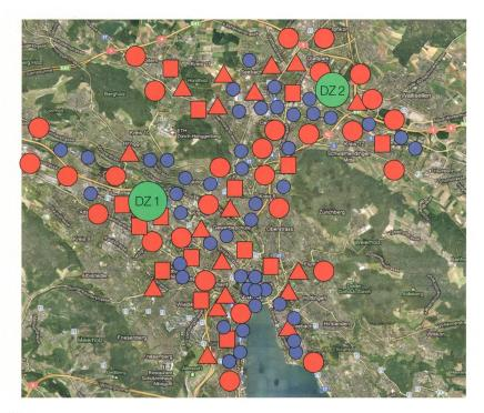
**Bild 3** In Albisrieden und in Zürich Nord werden 2012 die neuen Datenzentren (grün) mit den virtuellen Telefonzentralen in Betrieb genommen. 8000 Anschlüsse sind migriert (blau). Die meisten Anlagen (rot) sind noch alt.
