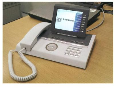
Bild 1 Diese neuen VolP-Telefone lösen sukzessive die zahlreichen älteren Modelle der Stadtverwaltung Zürich ab. Sie sind direkt ans Ethernet angeschlossen und werden via Power-over-Ethernet mit Strom versorgt.
