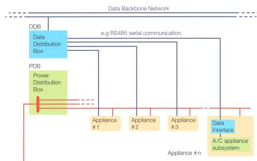
**Bild 2** Konventionelle Strom- und Datenübertragung für Avionikssysteme.
