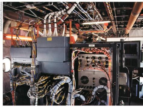
**Bild 1** Kabelsystem in einem Airbus A380.
