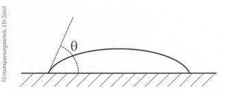
**Bild 3** Wassertropfen mit Kontaktwinkel  $\theta$  auf einer Ebene sitzend.
