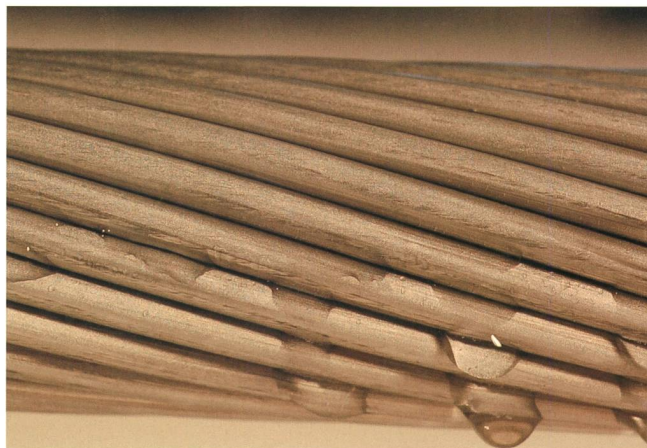
Bild 4 Wassertropfen auf einem besprühten neuen Seil ohne Behandlung (links) und mit Aufrauung (rechts).
