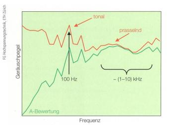
**Bild 2** Beispiel eines Spektrums der akustischen Emission einer Hochspannungsfreileitung mit und ohne A-Bewertung der Pegel.
