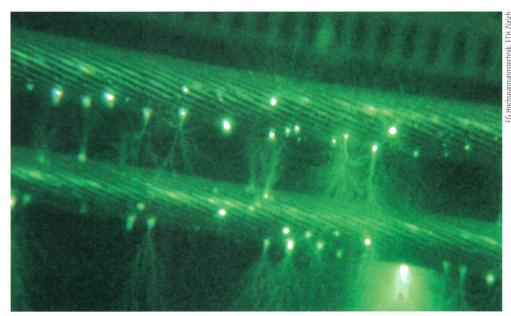
**Bild 1** UV-Aufnahme an zwei Hochspannungsleiterseilen mit starker Korona.
