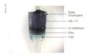
Figure 6 Lit catalytique permettant la production d'hydrogène dans l'un des prototypes de l'EPFL.
