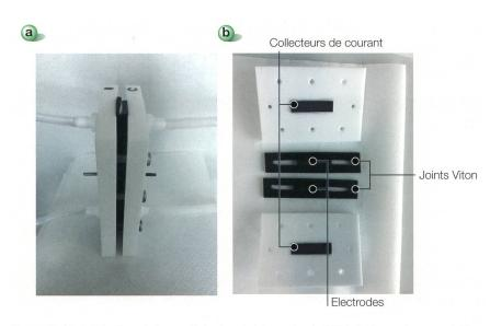
**Figure 2** (a) Cellule électrolytique utilisée dans le laboratoire de l'EPFL. (b) Deux plaques en Téflon permettent de maintenir ensemble les collecteurs de courant (graphite), les électrodes (feutre de graphite) placées au centre des entretoises (joints Viton) et la membrane (non représentée).
