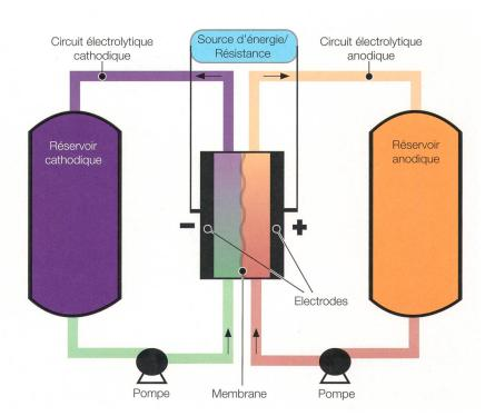
Figure 1 Schéma général d'une batterie redox.
