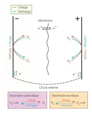
**Figure 3** Réactions électrochimiques à la surface des électrodes de la cellule électrolytique centrale.
