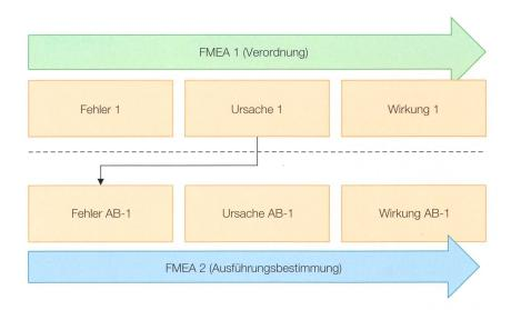
Bild 4 Stufenweises Vorgehen nach der Fehlermöglichkeits- und Einflussanalyse.
