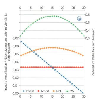
**Bild 2** (a) Beispiel für Netz mit wenig neuen und zahlreichen alten Anlagen (horziontal: % der Anlagen, vertikal: Alter der Anlagen), (b) Investitionsbedarf, Amortisation, Netznutzungsentgelt bezüglich CAPEX und Zeitwert im Verhältnis zum Neuwert beim entsprechenden Netz.
