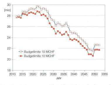
**Bild 1** Entwicklung des Netznutzungsentgelts bezüglich CAPEX beim Stadtwerk Lausanne für eine technische Lebensdauer von T=40 Jahren und eine jährliche Investitionslimite von 10 bzw. 15 Mio. CHF (2 bzw. 3 % des Wiederbeschaffungswerts). Die Abschreibedauer ist gleich der technischen Lebensdauer, WACC = 4,25 %.
