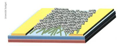
Feldeffekt-Transistor mit Halbleiterschicht aus einem Tabakmosaikvirus-(grün)-Zinkoxid-(grau)-Verbundmaterial, Siliziumdioxid-Dielektrikum (blau), elektrisch leitendes n-dotiertes Silizium-Substrat (rot) und Elektroden (gold).
