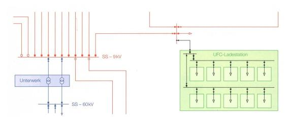
**Bild 2** Eine Tankstelle im 9-kV-Mittelspannungsnetz.
