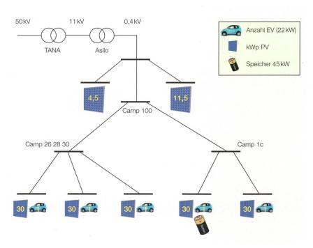
Bild 3 Niederspannungsnetz mit Elektroautos und Speichern.
