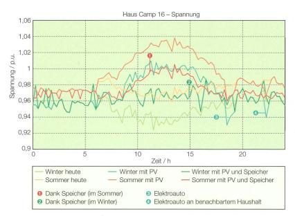
**Bild 4** Verlauf der Spannung am Hausanschlusskasten für je einen typischen Winter- und Sommertag in drei Szenarien (aktuell, mit PV-Anlagen, mit PV-Anlagen und einem stationären Speicher sowie diversen Elektroautos.
