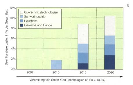
**Bild 4** Bis 2020 erwartet ABB, dass nur etwa 10 % der Gesamtlast beinflussbar sein werden. Voraussetzung dafür ist ein flächendeckend installiertes Smart Grid.
