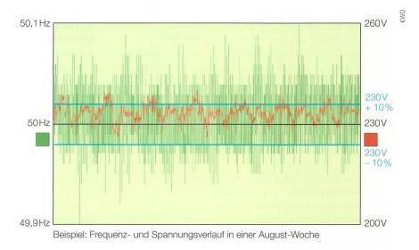
**Bild 2** Frequenz und Spannungsverlauf in einem Niederspannungsnetz (August): PV-Einspeisung führt zu Überspannungen (blaue Linien  $= \pm 10\%$  der Standardspannung).
