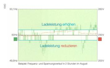
**Bild 5** Überschreitet die Spannung einen gewissen Schwellenwert, wird die Ladeleistung erhöht. Damit reduziert sich die Spannung wieder. Bei grossem Spannungsabfall schalten die Speicherladegeräte ab und warten, bis sich bessere Lastverhältnisse einstellen.
