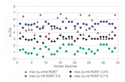
**Bild 2** Vergleich der Spannungsdifferenz in Abhängigkeit der Stufung. Die maximale Spannungsdifferenz, die für die Einhaltung des Spannungsbandes wichtig ist, beträgt für die vier Fälle: Istzustand  $\Delta u = 6,8\%$ , 6,7% Stufung  $\Delta u = 5,5\%$ ; 4,3% Stufung  $\Delta u = 3,7\%$ ;  $2 \times 2\%$  Stufung  $\Delta u = 2,6\%$ , RONT steht für regelbarer Ortsnetztransformator.
