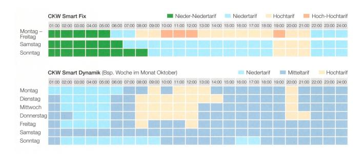
**Bild 2** Die zwei dynamischen Tarife des Pilotprojekts.
