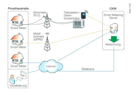
**Bild 3** Kommunikationsverbindungen im Pilotprojekt.
