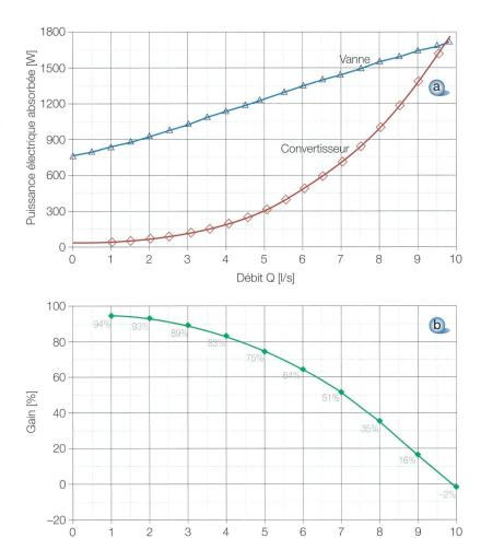
Figure 3 (a) Puissances électriques consommées. (b) Gain sur la puissance absorbée.
