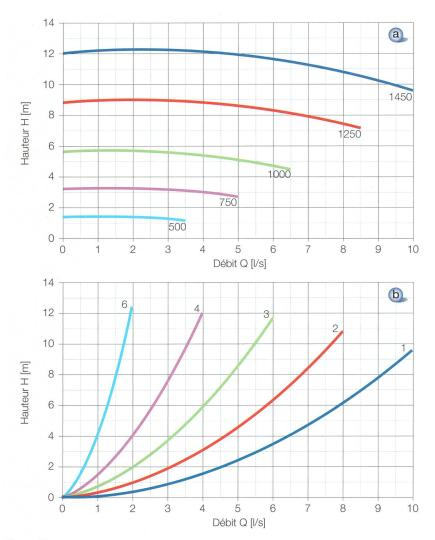
Figure 2 Caractéristiques H(Q) mesurées.
