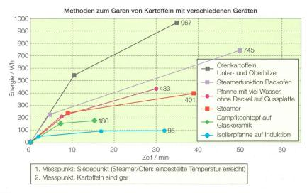
**Bild 5** Verlauf des Energieverbrauchs beim Garen von 500 g Kartoffeln. Bei der Isolierpfanne wurde ein dritter Messpunkt festgehalten: 1. Siedepunkt («Dampffähnchen»), 2. Kochfeld ausgeschaltet, 3. Kartoffeln auf dem Warmhalteuntersatz fertiggegart.
