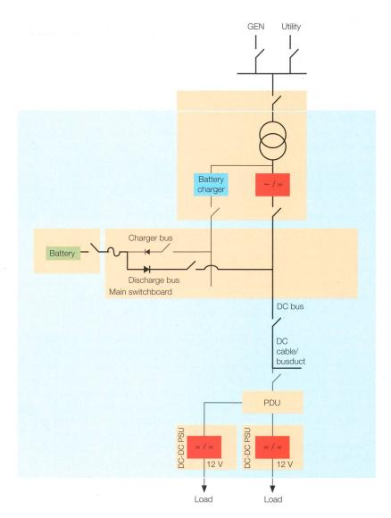
Bild 4 Übersichtsschema der DC-Stromversorgung.
