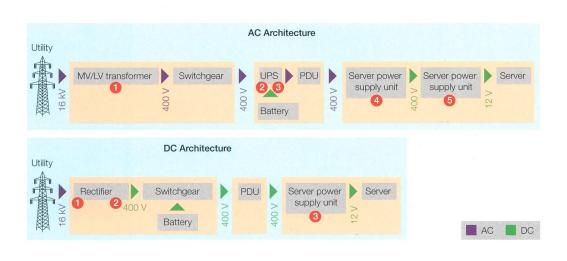
**Bild 3** Vergleich der Wechselstrom- mit der einfacheren und energieeffizienteren Gleichstrom-Architektur.
