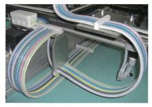
Gewebebandkabel können teure Spezialkabel ersetzen.
