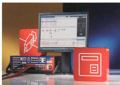
RelayLabTest vereinfacht simulationsbasierte Typ- und Akzeptanzprüfungen.
