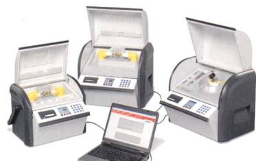
Baur-Prüfgeräte ermöglichen eine detaillierte Zustandsbewertung des Isolierstoffes.
