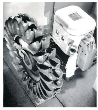
Bild 3 Zerstörungsfreie Prüfung einer Peltonturbine mittels Zweistrahlbetatron. Die Strahlfelder sind durch Metallstäbe visualisiert. Auf der Rückseite des Turbinenrades sind die Filmkassetten für Fotoaufnahmen befestigt.
