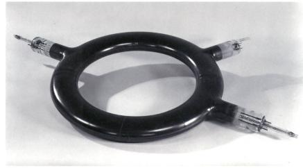
Bild 1 Elektronen-Kreisröhre aus Hartglas, das Herzstück des Betatrons.
