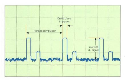
Figure 4 Signal d'impulsion démodulé provenant de 2 émetteurs.
