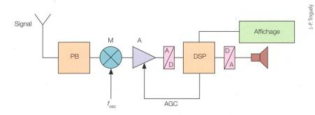
Figure 6 Principe de fonctionnement d'un récepteur DVA.
