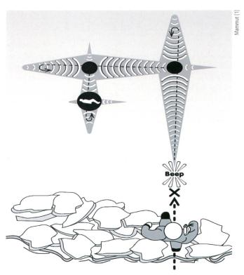
**Figure 1** Procédé de recherche orthogonal des DVA analogiques.
