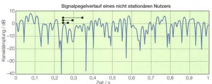
**Bild 3** Änderungen des Empfangspegels  $L_e$  bei bewegtem Empfänger. Die zwei Beispiele zeigen den Einfluss von Fading auf die Datenpakete verschiedener Dauer auf (100 ms, 50 ms und 25 ms, dargestellt als drei schwarze Balken).
