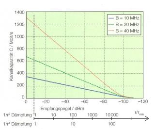
**Bild 2** Maximale Kanalkapazität gemäss der Shannon-Grenze für verschiedene Bandbreiten in Abhängigkeit vom Empfangspegel L<sub>e</sub>.
