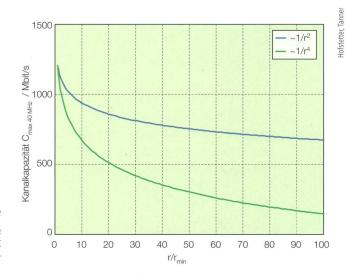
**Bild 1** Maximale Kanalkapazität C<sub>max 40 MHz</sub> in Abhängigkeit vom Abstand zur Basisstation.
