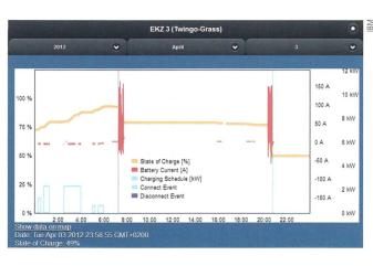
**Bild 4** IBM EV-Manager-Anwendung für Smartphones und Webbrowser. Visualisierung des gesteuerten Ladens.
