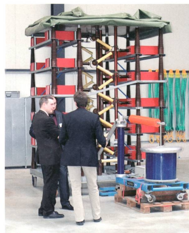
Mehrstufiger Marx-Generator der FKH für Stossspannungsprüfungen.
