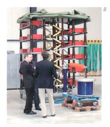
Mehrstufiger Marx-Generator der FKH für Stossspannungsprüfungen.
