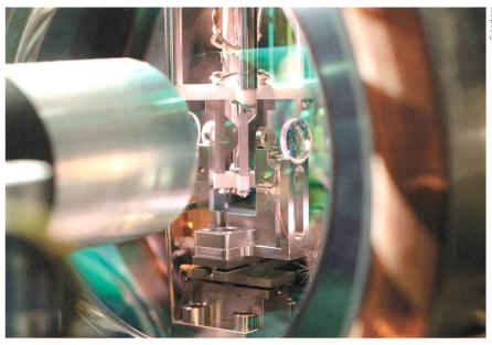
Herzstück des Experiments ist ein optischer Resonator, der aus Spiegeln besteht, zwischen denen die Photonen bis zu 25 000-mal reflektiert werden, bevor sie in einen Lichtleiter gekoppelt werden.
