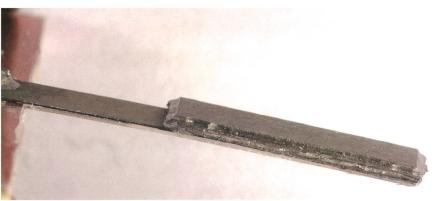
**Figure 6** Récupérateur piézoélectrique d'énergie de vibrations mécaniques fabriqué sur un substrat souple (PEN ou polynaphtalate d'éthylène, 15 x 3 mm²) par laminage d'une feuille piézoélectrique de PZT et ajout d'une masse en tungstène pour diminuer la fréquence de résonance à 105 Hz. Une puissance de 3,6 μW peut être générée sous une accélération de 0,5 g [7].
