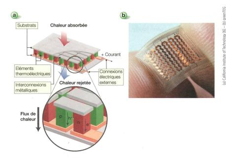
**Figure 4** (a) Un dispositif thermoélectrique génère une tension lorsqu'il y a une différence de température, les porteurs de charge diffusant du côté le plus chaud au côté le plus froid. (b) Exemple d'un générateur thermoélectrique miniaturisé réalisé par greenTEG [5] sur un substrat souple.
