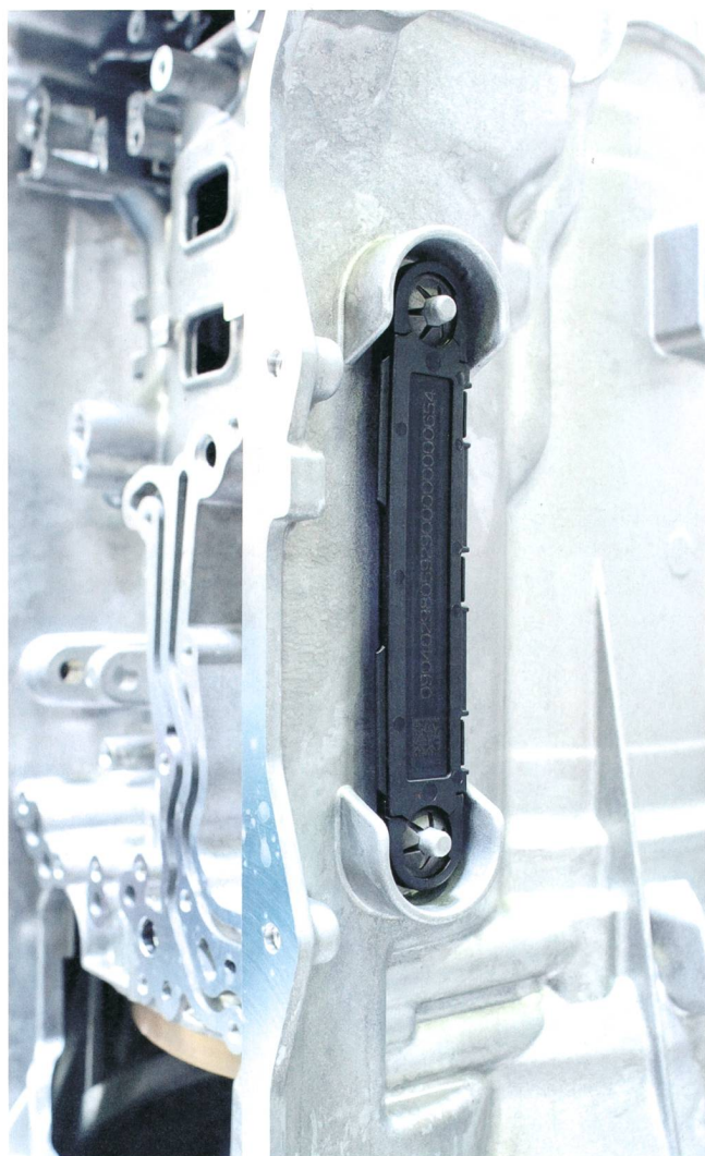
Bild 2 ZF-Getriebe werden dauerhaft mit EPC-RFID-Tags ausgerüstet.
