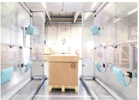
**Bild 1** Identifikation von Ware per RFID in der Logistik.
