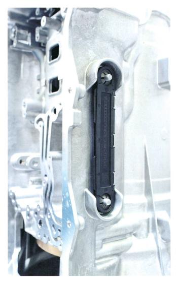
**Bild 2** ZF-Getriebe werden dauerhaft mit EPC-RFID-Tags ausgerüstet.
