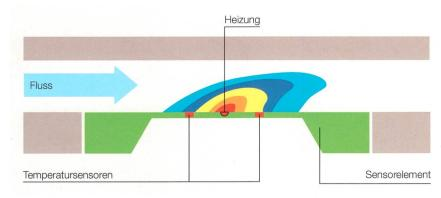
Bild 1 Funktionsprinzip eines thermischen Strömungssensors.
