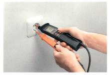
Ein versehentliches Auslösen des FI-Schutzschalters beim Prüfen ist ausgeschlossen.
