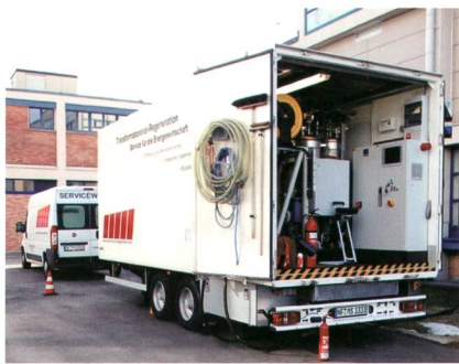
Die mobile Transformatorenöl-Regenerationsanlage inklusive Online-Monitoring.
