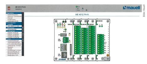
Bild 2: Über den integrierten Web-Server lässt sich das Fernwirksystem parametrieren.
