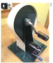
Mittels Körperkraft lässt sich Strom erzeugen.
