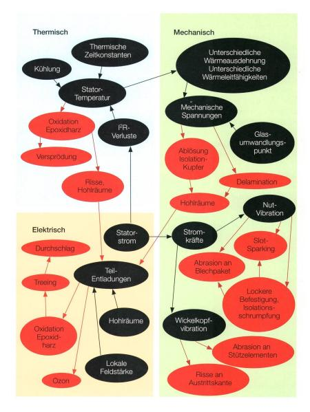
**Bild 1** Thermische, elektrische und mechanische Alterungs- und Schadensmechanismen. Schwarz markiert sind betriebs- und konstruktionsbedingte Einflussgrössen. Rot markiert sind Alterungs- und Schadensmechanismen. Die Pfeile verdeutlichen Interaktionen.
