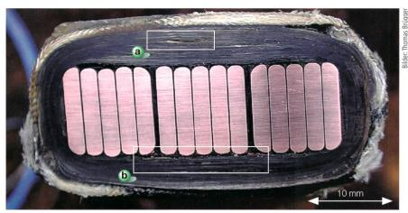
**Bild 3** a) Delaminationen zwischen Glimmerbandlagen, b) Ablösungen zwischen Kupferleiter und Hauptisolation.
