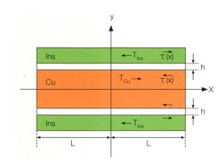
**Bild 2** Mechanische Kräfte in Isolation und Kupferleiter des Statorstabs.
