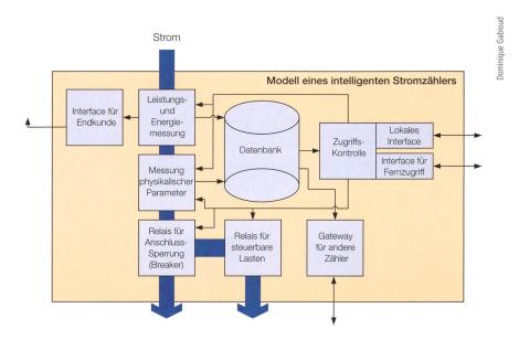
**Bild 1** Modell-Architektur eines intelligenten Stromzählers [1].
