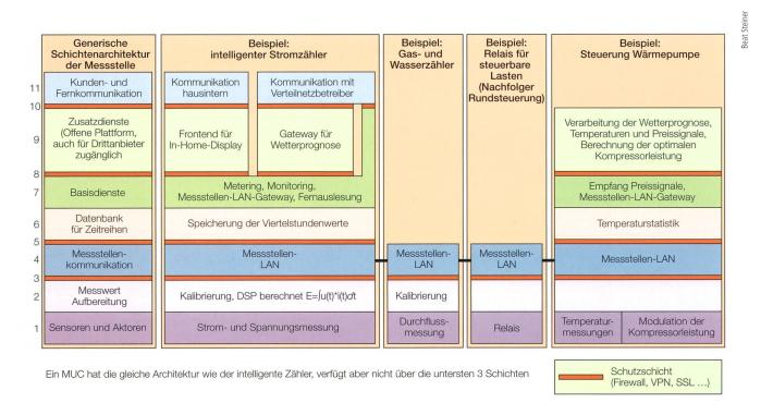
Bild 2 Geschichtete Architektur einer intelligenten Messstelle (Beispiel).
