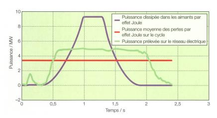
Figure 5 Principe de limitation de la puissance prélevée sur le réseau électrique.
