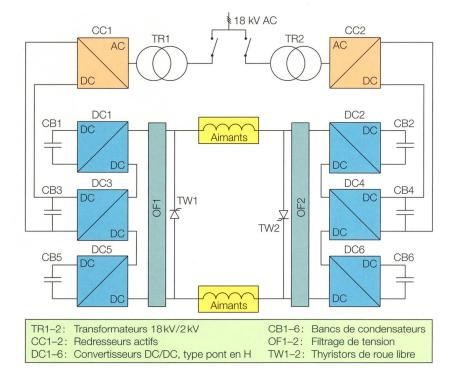
Figure 3 Topologie du nouveau système de puissance du PS avec deux chargeurs (CC1 et CC2), 6 convertisseurs DC/DC (DC1-DC6) et 6 bancs de condensateurs (CB1-CB6).
