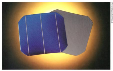
Prototype de cellule photovoltaïque métallisée par sérigraphie et passivée par une double couche d'ICP-AlO,/SiN,.. Ces cellules affichent un rendement de 20,1 %.
