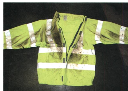
Swiss-ARC-Fleecejacke nach bestandem Lichtbogen-Test.
