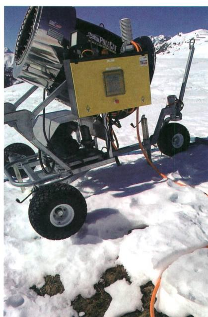
**Illustration 3** Câble non protégé vers l'armoire de distribution. **Non conforme à la norme !**
