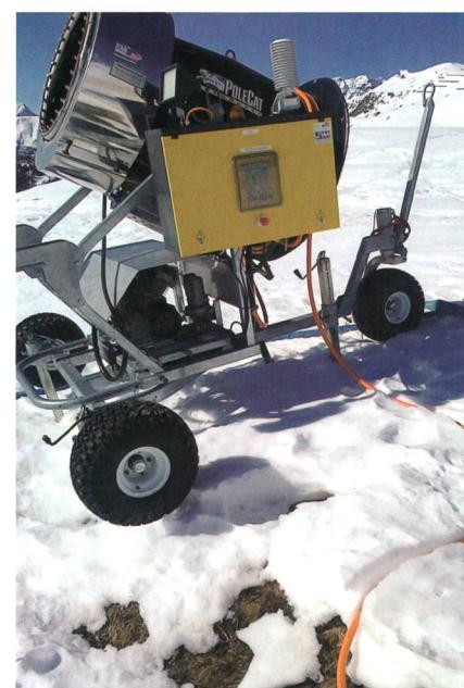
Figura 3 Cavo di alimentazione dell'armadio di distribuzione non protetto. **Non conforme alle norme!**
