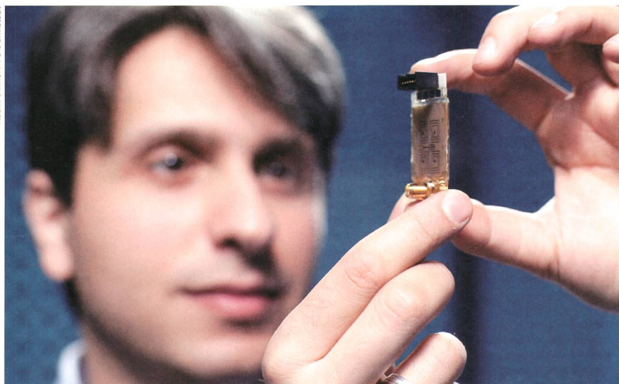
Karabey et le prototype de l'antenne satellite capable d'être orientée en l'espace de quelques millisecondes.
