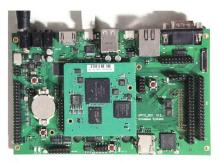
**Figure 3** Le système embarqué APF51 d'Armadeus Systems.
