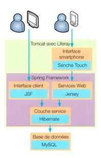
**Figure 4** Illustration des différentes couches technologiques Java EE utilisées dans le système d'information ePark. Les applications client fonctionnent en mode Web classique ou sur smartphone via des applications HTML5 et JavaScript consommant les Services Web exposés par le serveur.
