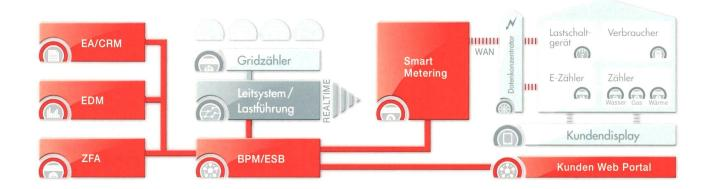
**Bild 1** Übersicht über das neue System bei den Werkbetrieben Frauenfeld. Die Integrationsplattform (BPM/ESB) verbindet alle IT-Systeme in der Zentrale miteinander.
