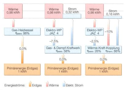
**Bild 3** Basismodell Wärme und Strom. Aus der Primärenergie wird immer die gleiche Menge Wärme erzeugt. Durch die höhere Systemeffizienz der WKK- und GuD-Strategie gegenüber einem Gaskessel fällt zusätzlich Strom an.
