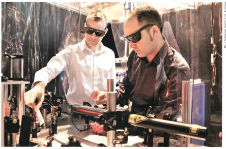
Les chercheurs de l'Institut Paul Scherrer Loïc Le Guyader (gauche) et Souliman El Moussaoui ajustent le laser permettant de chauffer l'échantillon magnétique.
