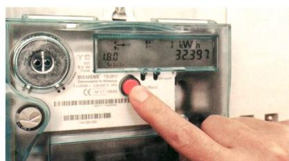
Power Snap Shots aus Smart Meters von Siemens liefern zeitsynchrone Netzenkenngrößen.
