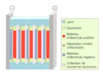
**Figure 2** Architecture générique de la batterie bipolaire.
