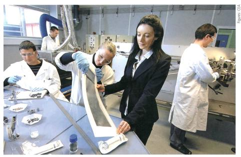
Figure 6 L'élément bipolaire CEA LiFePO<sub>4</sub>/ Li<sub>4</sub>Ti<sub>5</sub>O<sub>12</sub> 24 V 15 Wh peut être fléchi.
