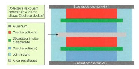
Figure 4 Technologie Li-ion bipolaire à collecteur aluminium brevetée par le CEA en 2001 [10].
