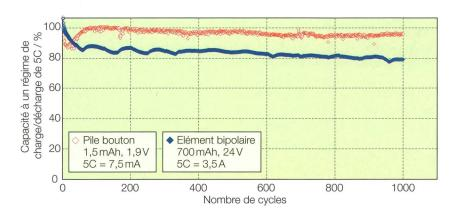
**Figure 5** Performance d'un élément bipolaire 24 V à 13 compartiments LiFePO<sub>4</sub>/ Li<sub>4</sub>Ti<sub>5</sub>O<sub>12</sub> à régime accéléré (5C = 5 fois la capacité nominale). Comparaison avec une pile bouton intégrant le couple LiFePO<sub>4</sub>/ Li<sub>4</sub>Ti<sub>5</sub>O<sub>12</sub> (1,9 V).
